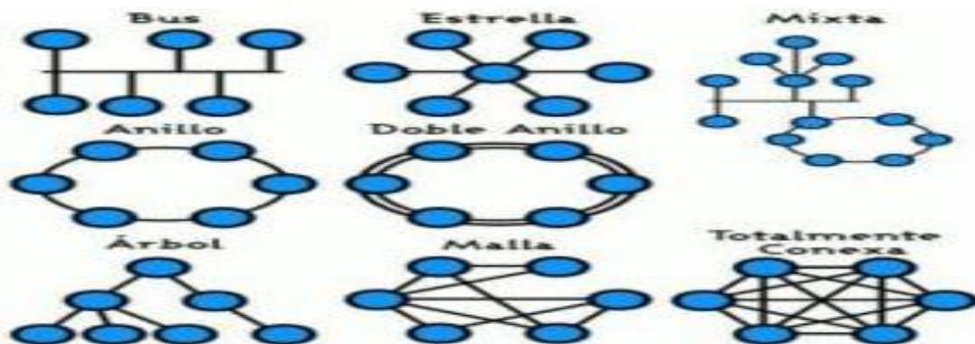
**Bus:** La topología de bus tiene todos sus nodos conectados directamente a un enlace y no tiene ninguna otra conexión entre nodos. Una topología de bus hace posible que todos los dispositivos de la red vean todas las señales de todos los demás dispositivos.. Esto representa una ventaja si desea que toda la información se dirija a todos los dispositivos. Sin embargo, puede representar una desventaja ya que es común que se produzcan problemas de tráfico y colisiones.
